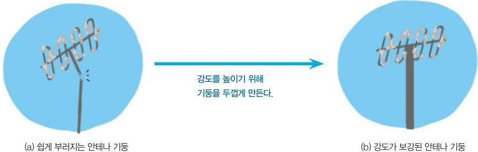
그런데 [그림 1-18]의 (b)와 같은 해결안은 또 다른 문제를 유발한다. 기둥의 강도가 보강되면 안테나 기둥은 쉽게 부러지지 않겠지만, 안테나 무게가 증가하여 한 명이 쉽게 운반하기 어렵게 되는 것이다. 강도를 좋게 하면 무게가 무거워지고, 반대로 무게를 가볍게 만들면 강도가 약해지는 상황이 발생한 것이다. 즉, 강도와 무게라는 두 가지 특성을 모두 만족시키는 것이 기술적으로 불가능한 상황이다. 트리즈에서는 이러한 상황, 즉 하나의 특성이 좋아지면, 다른 특성이 나빠지는 상황을 기술적 모순으로 정의한다.
