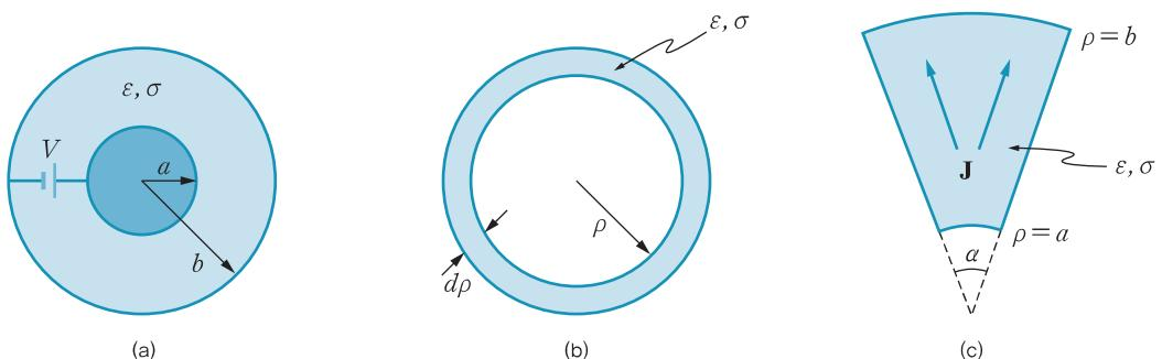
[그림 5-10] 내부 도체 반지름이  $a$ , 외부 도체 반지름이  $b$ , 길이가  $l$ 인 동축선로
