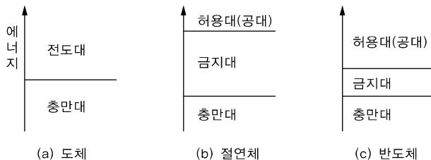
[그림 3-3] 절대 영도에서의 도체, 절연체, 반도체의 대 구조
