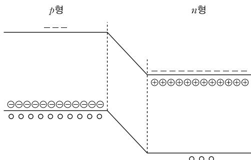
[그림 3-17]  $p$ 형 반도체와  $n$ 형 반도체의 접합
